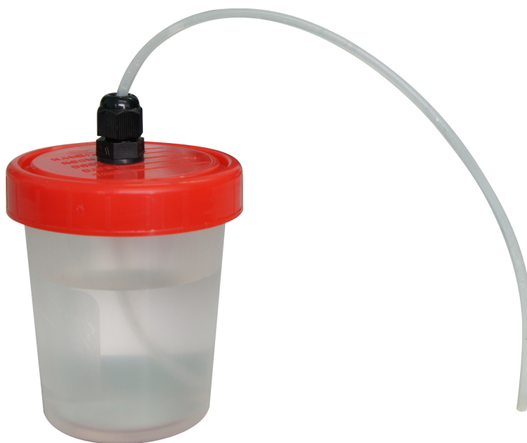
Рисунок 10 – Стакан с титрантом и трубкой
